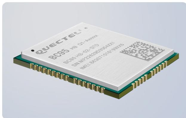
BC95 是一款高性能、低功耗的 NB-IoT 无线通信模块。其尺寸仅为 19.9mm × 23.6mm × 2.2mm，能最大限度地满足终端设备对小尺寸模块产品的需求，同时有效地帮助客户减小产品尺寸并优化产品成本。BC95 在设计上兼容移远通信 GSM/GPRS 系列的 M35 模块，方便客户快速、灵活的进行产品设计和升级。
