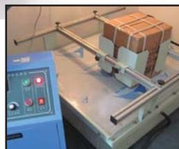
模拟运输振动试验机
