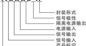
TxxxxAP 系列信号调理模块，是前级正负信号输入，后级单极性信号输出的有源隔离模块，模块内部嵌入了一个高效微功率电源，可以在向内部信号处理电路供电的同时向外围电路输出一路隔离电源。在三线制和四线制应用场合，该产品大大简化了用户的设计，提高了PCB的空间利用率。由于内部采用电磁隔离技术，相比光耦隔离具有更好的温漂特性和线性度。此模块为四端隔离，信号输入、信号输出、电源输入和隔离电源输出相互隔离。
