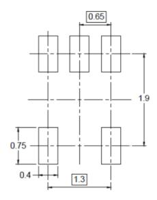
RECOMMENDED PCB LAYOUT PATTERN (Unit: mm)
