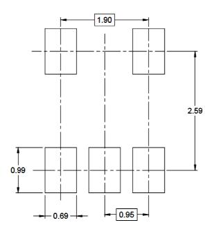
RECOMMENDED PCB LAYOUT PATTERN (Unit: mm)
