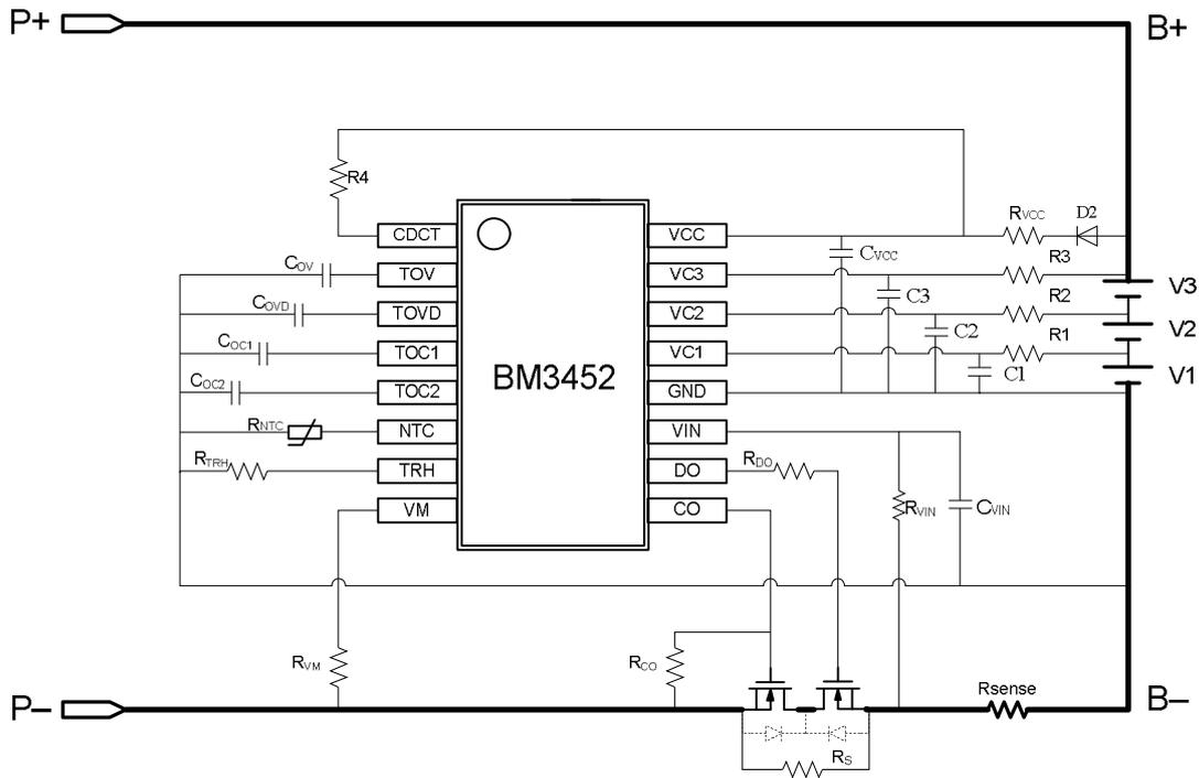
图 6 3 串典型应用——充放电 NMOS 控制，回路共用
