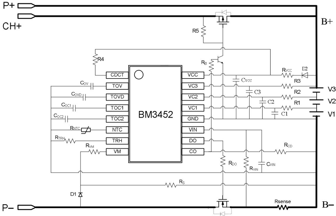
图 8 3 串应用——充电 PMOS，放电 NMOS 控制
