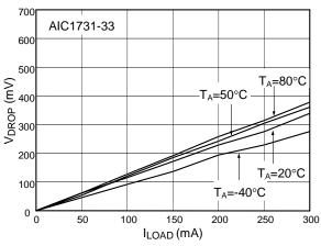
Fig. 2 V<sub>DROP</sub> vs. I<sub>LOAD</sub>
