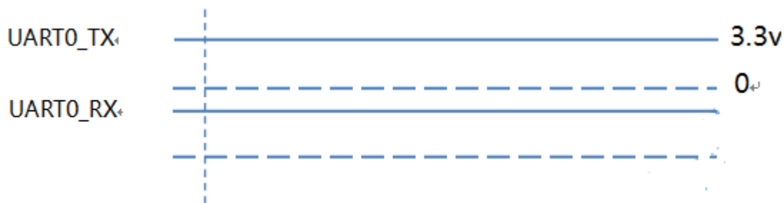
正常无数据发送状态
