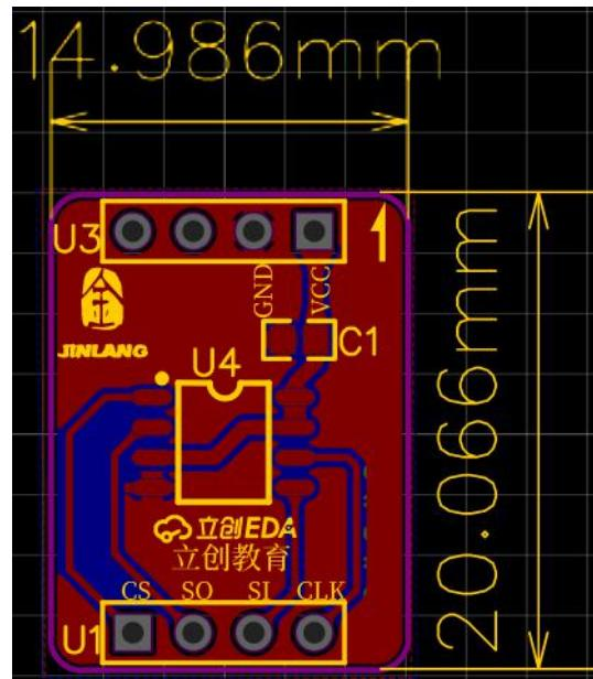
VCC: 该模块的供电电压为 3.3V, 由开发板进行供电;
