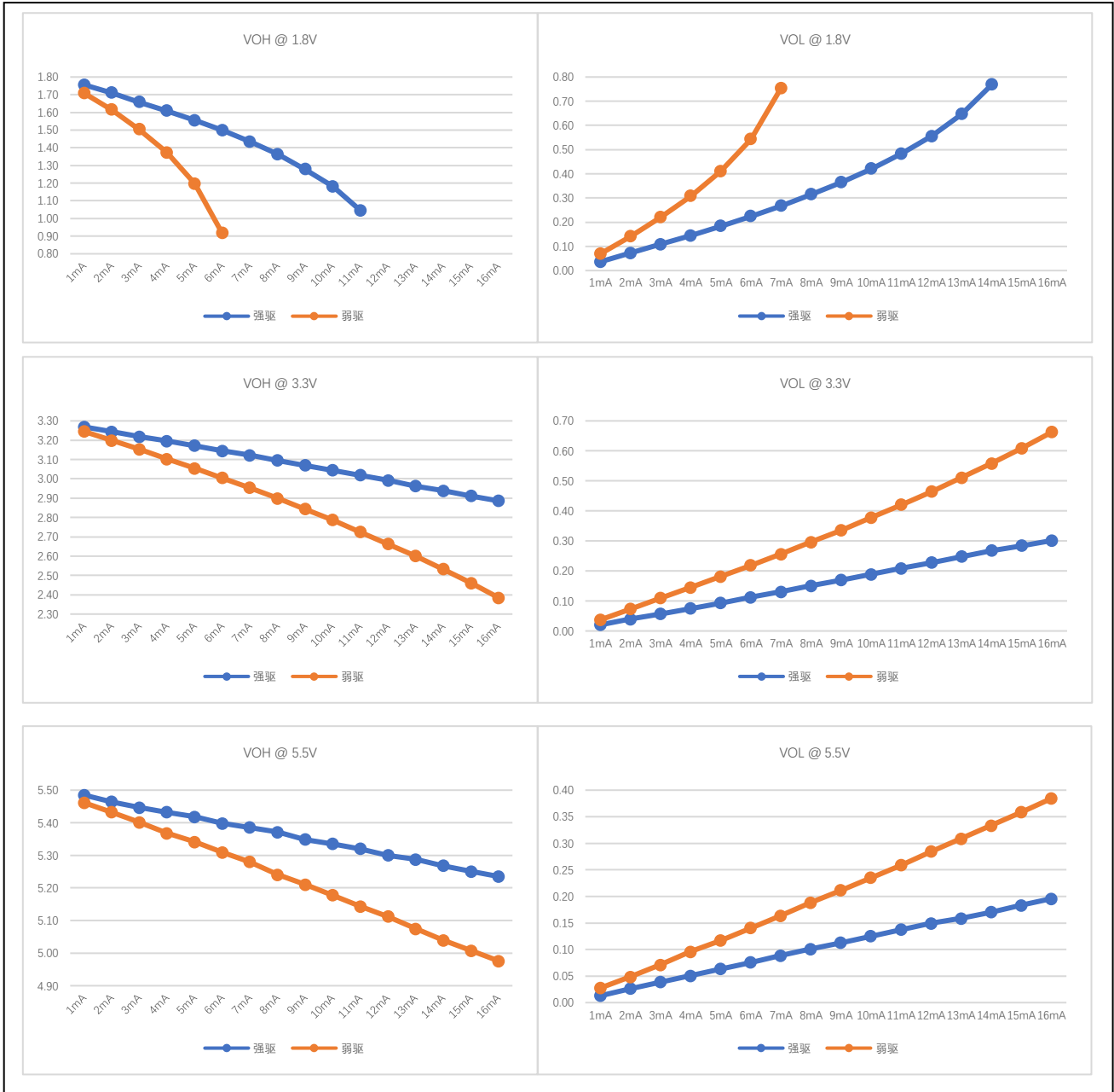
图 7-2 输出端口 VOH/VOL 实测曲线
