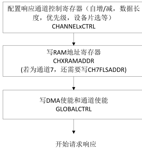
图 18-1 DMA 寄存器配置
