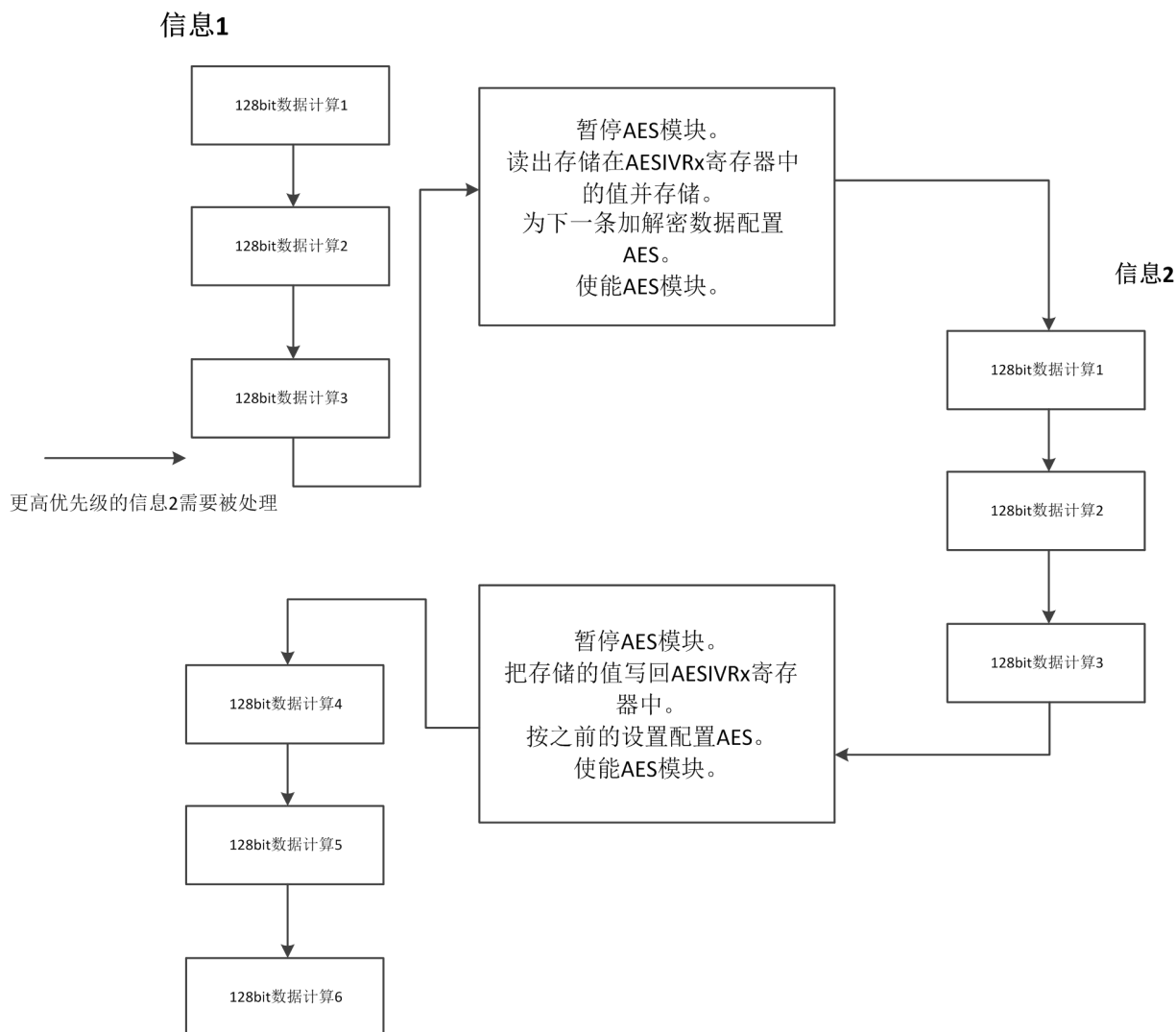
图 9-5 暂停模式流程
