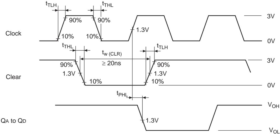
Note: Input pulse:  $t_{TLH} \leq 15 ns$ ,  $t_{THL} \leq 6 ns$
