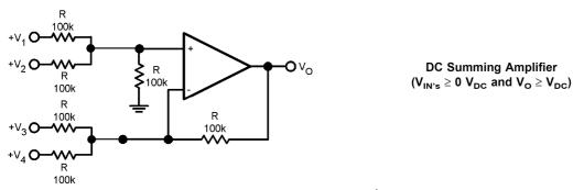
Where: V<sub>0</sub> = V<sub>1</sub> + V<sub>2</sub> - V<sub>3</sub> - V<sub>4</sub>, (V<sub>1</sub>+ V<sub>2</sub>)  $\geq$  (V<sub>3</sub> + V<sub>4</sub>) to keep V<sub>O</sub> > 0 V<sub>DC</sub>
