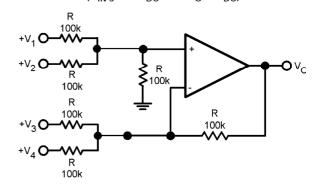
Where:  $V_0$  =  $V_1$  +  $V_2$  -  $V_3$  -  $V_4$ ,  $(V_1$ +  $V_2) \ge (V_3$  +  $V_4)$  to keep  $V_O$  > 0  $V_{DC}$
