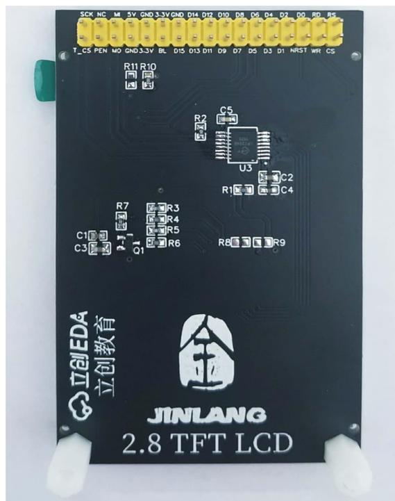
图 1.3.2 寸 TFTLCD 背面
