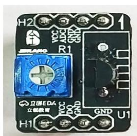
图 1.4.2 DS18B20/DHT11/ADC 模块
