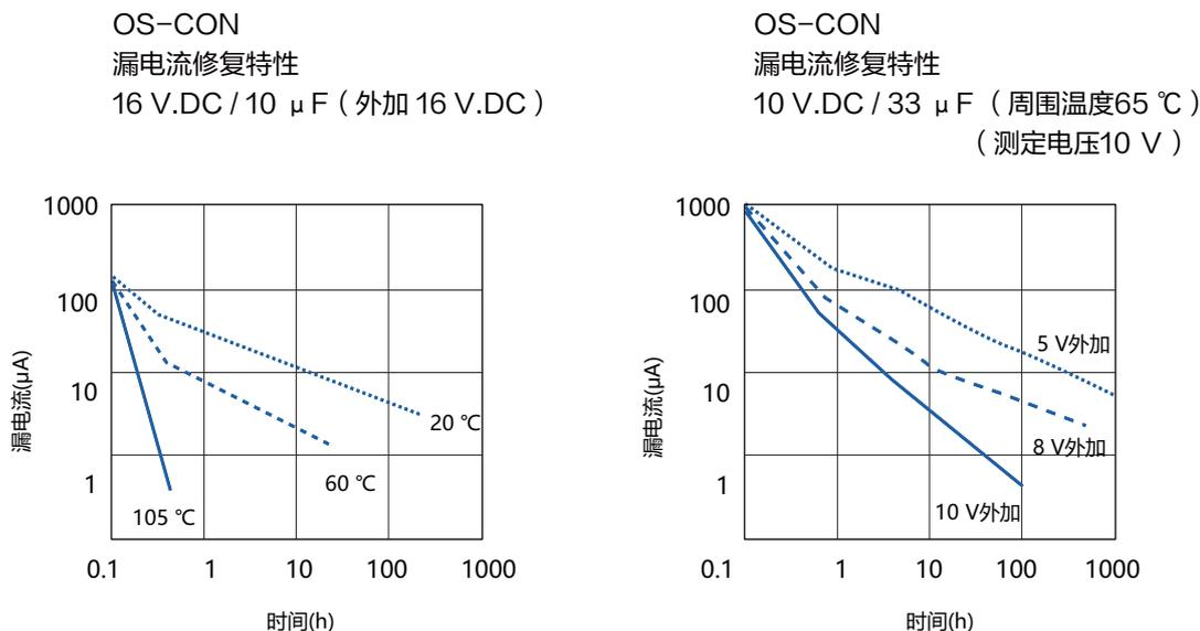
※ 为了更清楚地表示漏电流的修复，使用了故意给OS-CON施加应力增大了漏电流值的样本
