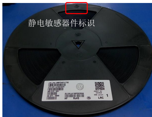
13英寸卷盘标签张贴及QA印章位置
