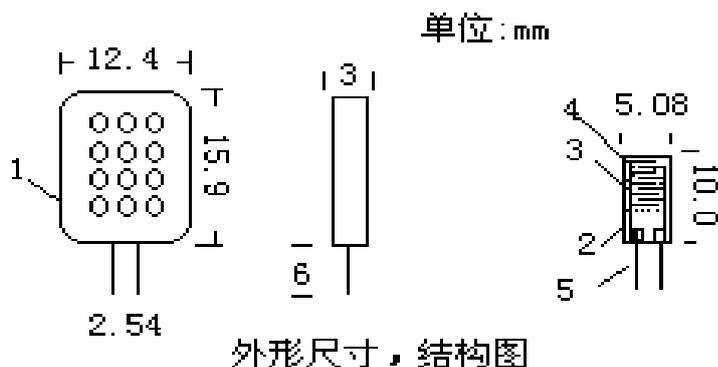
图 2: 1—外壳 (ABS) 2—基片 (AL203) 3—电极 4—感湿材料 5—引脚
