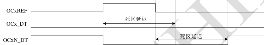
Figure 54 死区时间大于 OCxREF 有效电平宽度时的死区插入
