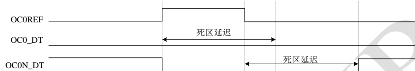
Figure 87 死区时间大于 OC0REF 无效电平宽度时的死区插入
