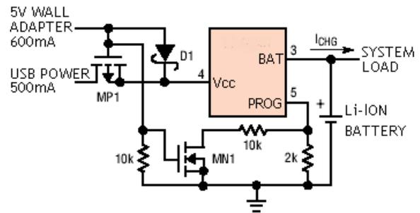
图 5：交流适配器与 USB 电源的组合
