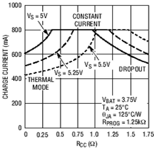
图 4：充电电流与 Rcc 的关系曲线
